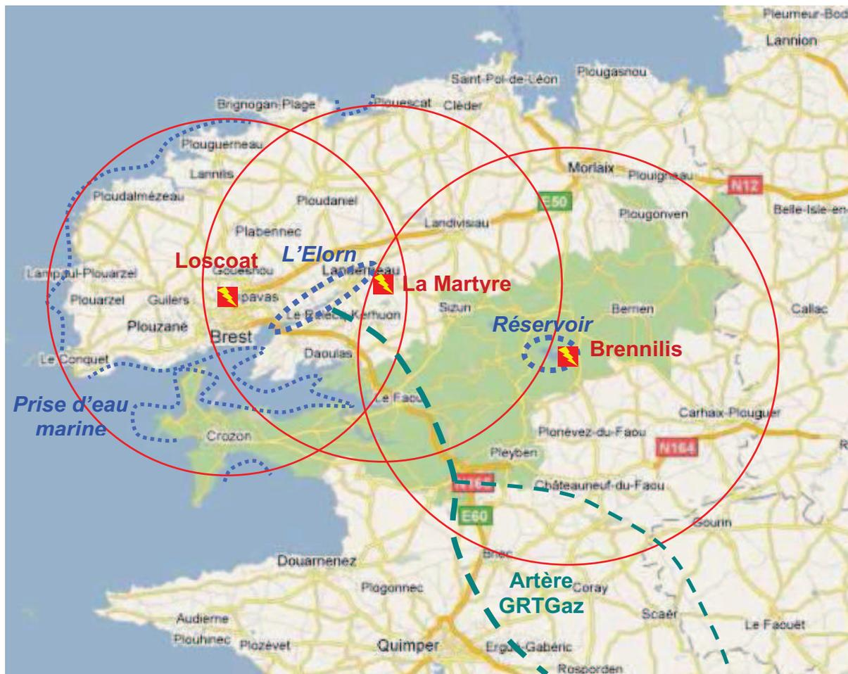
Sur ce plan de situation, nous avons indiqué les arrivées possibles des différents raccordements du projet de Cycle Combiné à Gaz. L'appel d'offres fixe notamment trois contraintes à l'implantation du Cycle Combiné :
